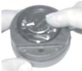
Fig. 64 -INSERTING BATTERY
